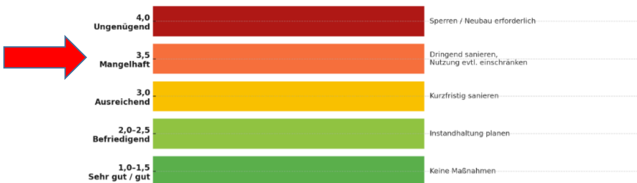
Notenstufen bei Brückenprüfungen (DIN 1076)
